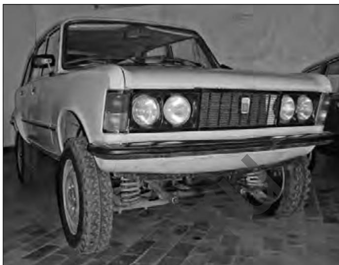
*Опытный полноприводный внедорожник на базе универсала 1977 г.*
