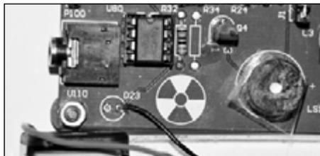
Подключение транзисторного ключа к плате индикатора радиоактивности RadiationD-v1.1(CAJOE)
